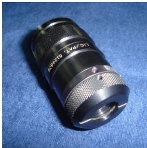
Figura 2.15: Ensamble óptico serie 80X60 para el sistema láser Nd:YAG.
