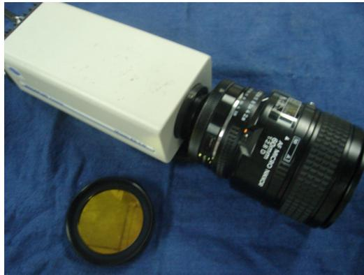
Figura 2.16: Cámara CCD Kodak Megaplug ES1.0 y filtro verde.
