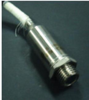
Figura 2.9: Transductor de presión Druck Tipo PDCR 810.
