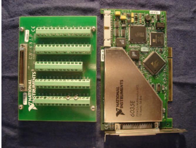
Figura 2.12: Tarjeta de adquisición de datos PCI-6035E.
