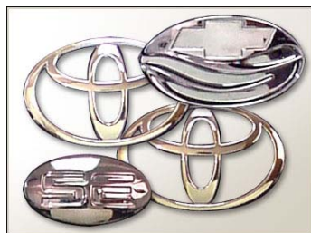
→ Fig. 46 Partes automotrices recubiertas con capas cerámicas por PVD de la empresa Siegel-Robert Automotive
