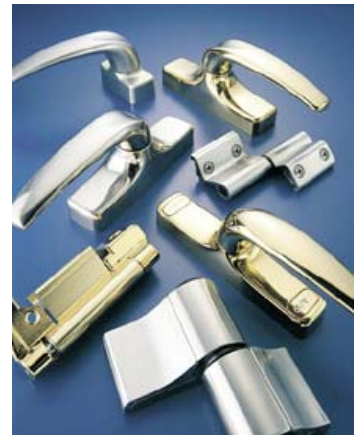
→ Fig. 39 Pomos y bisagras de puertas en aluminio fundido recubiertas con nitruro y carburo de titanio por PVD, de la empresa SAVIO.
