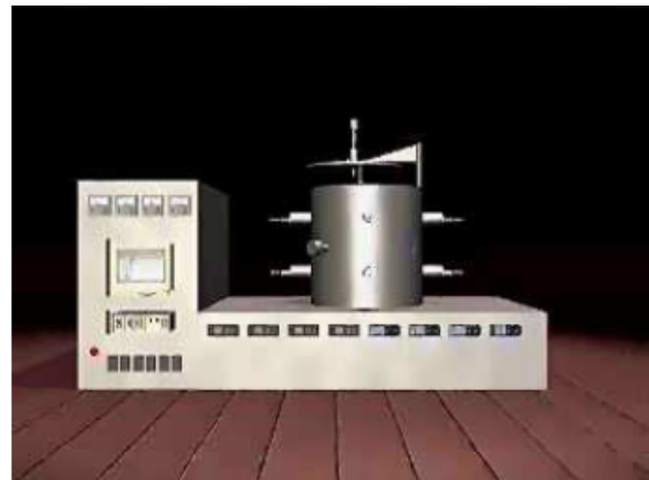
Fig. 44 Esquema de un sistema industrial monoevaporador PAPVD, desarrollado por LAFIP. Fuente: LAFIP
