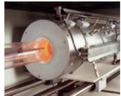
Reactores de pared caliente Uso de laboratorio. Fuente: CVD Equipment Corporation ↑
