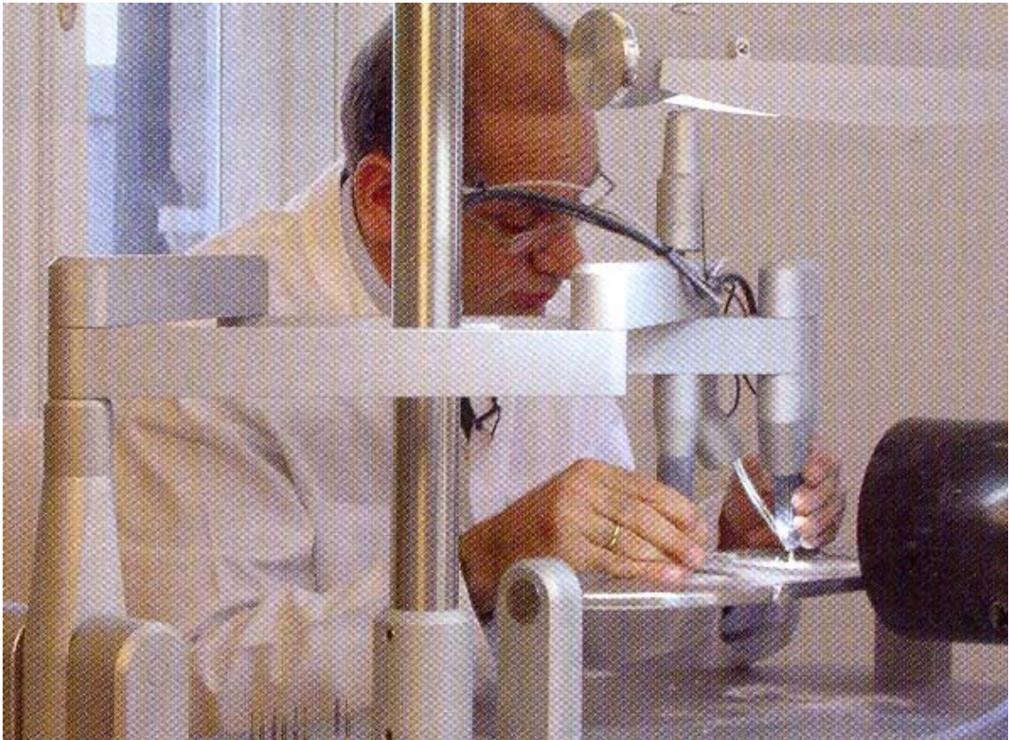
Fig. 8. El investigador Enrico Steger con su aparato Zirkon Zahn en el trabajo. Se trata de una fresadora copiadora para el procesamiento de cerámica de dióxido de zirconio como pieza verde. El protésico dental ajusta la estrategia de fresado a la forma del objeto.
