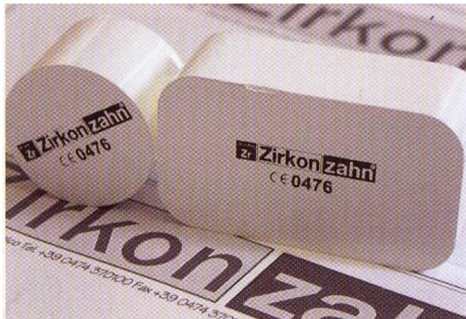
Fig. 9. La pieza en verde del material de dióxido de zirconio presintetizado se distribuye en siete tamaños de piezas crudas.
