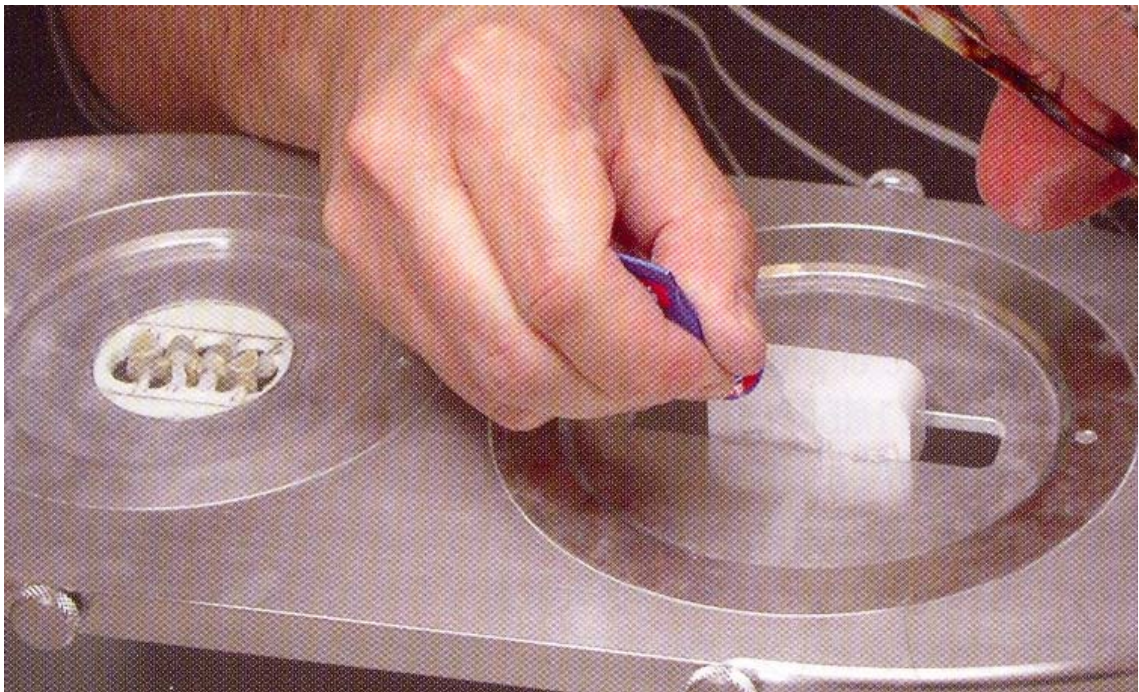
Fig. 18. Para un aprovechamiento óptimo, el bloque se monta, según el caso, en una placa de aluminio prefabricada. El bloque restante puede sujetarse repetidamente para diferentes casos
