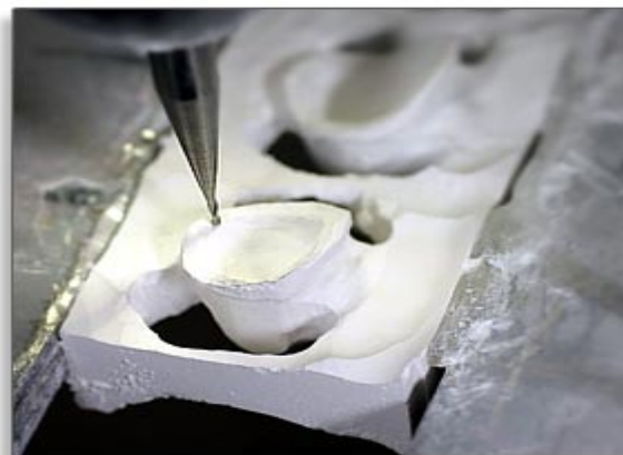
Fig. 21 Objeto cerámico durante el fresado
