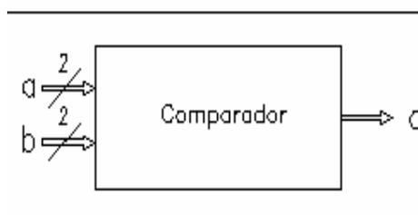
Figura 5.3 Comparador de igualdad de dos bits<sup>65</sup>
