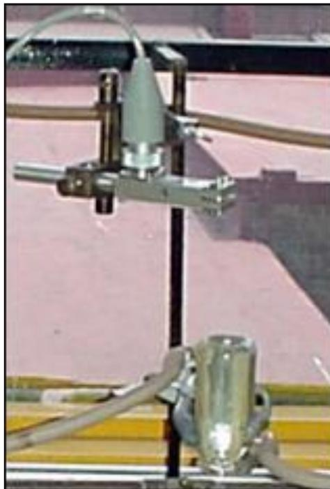
Fotografía No.6 Cámara para estudio convencional “In Vitro” (abajo), transductor de fuerza isométrica (GRASS INC) y tensor milimétrico.
