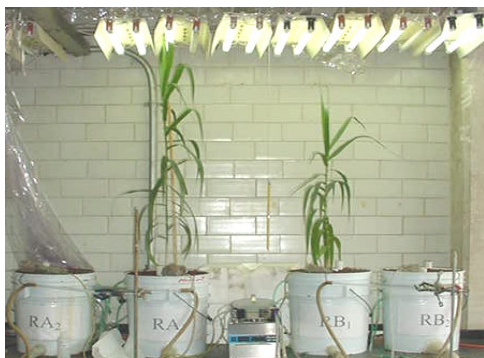
Figura 2.5 Sistema de un HAFVD a escala de laboratorio utilizado en la investigación
