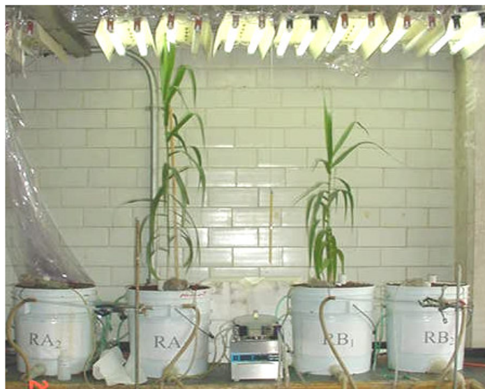
Figura A.6.3 Sistema experimental en la etapa final de los experimentos, con los brotes de las hidrofitas (RA 1 : 1.05 m de altura y 5 mm de diámetro; RB 1 : 0.86 m de altura y 9 mm de diámetro y más follaje que RA 1 )
