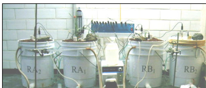
Figura 3.4 Instalación de los electrodos en el sistema experimental
