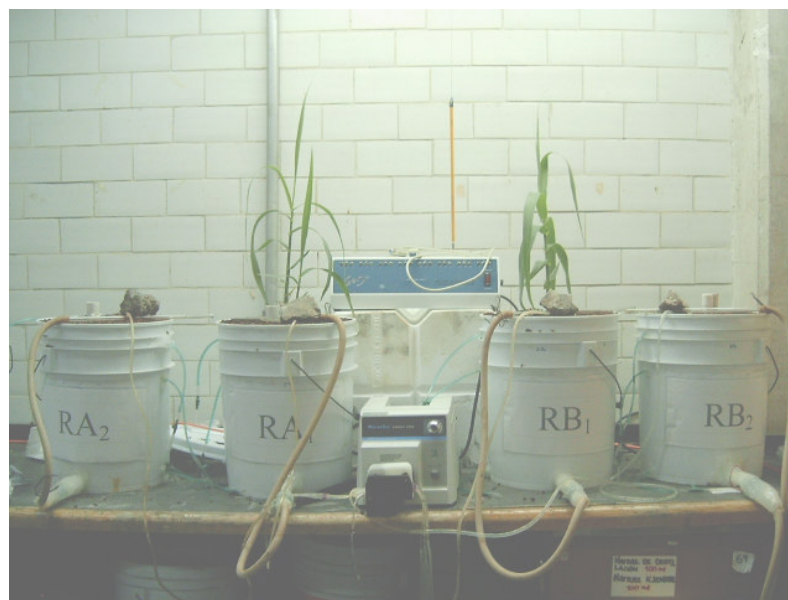
Figura A.6.2 Sistema experimental en la etapa intermedia de los experimentos, con los brotes de las hidrofítas de menos de 50 cm de altura
