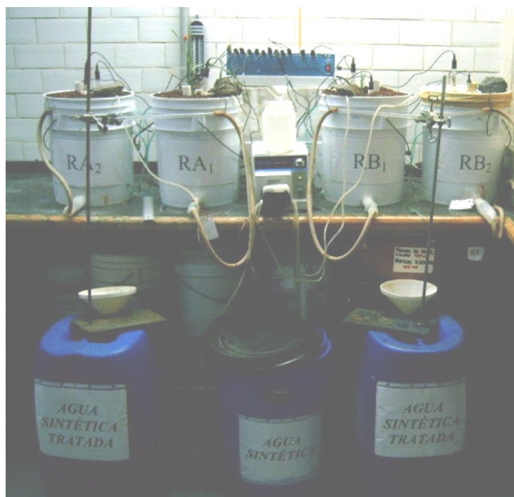
Figura A.6.1 Sistema experimental al inicio de los experimentos, con los brotes de las hidrofítas de menos de 8 cm de altura
