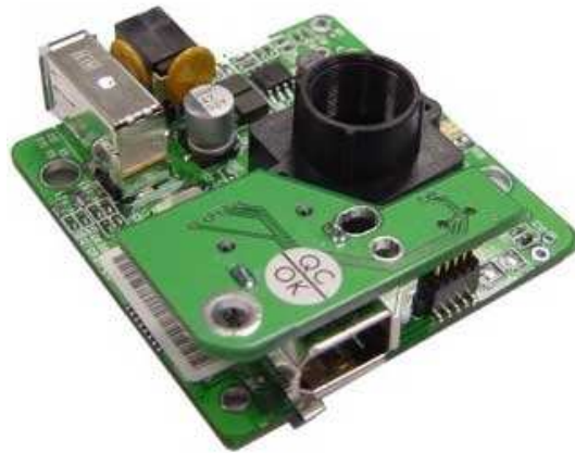
Figura 5.1: Cámara Unibrain utilizada en el sistema
