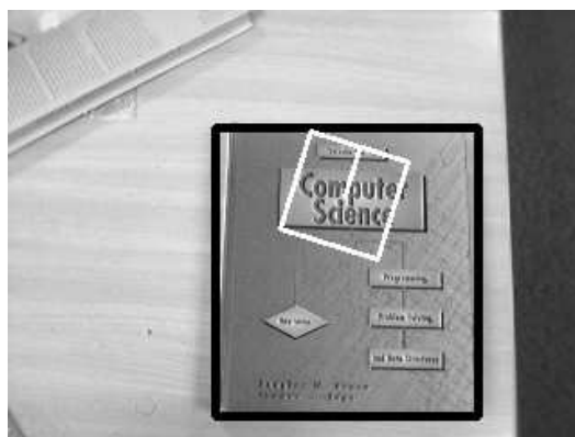
Figura 4.4: Región de interés para una sola característica mostrando la orientación y el tamaño de la ventana del descriptor en una escala fija
