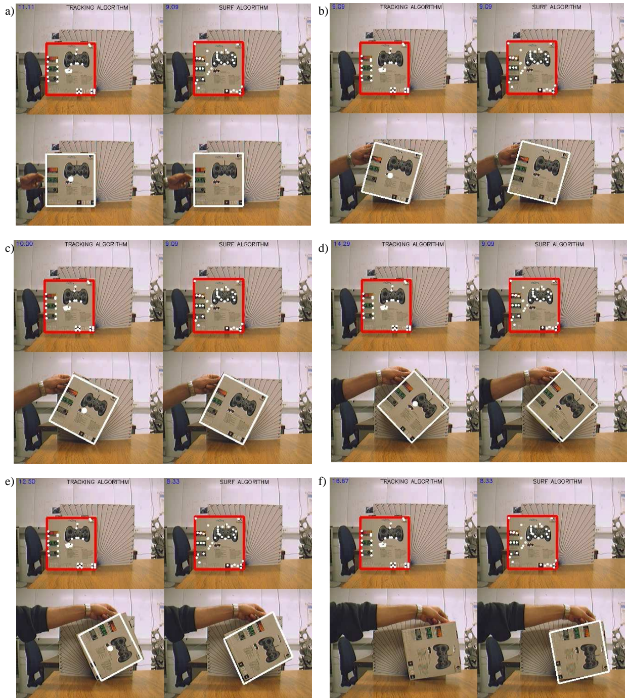
Figura B.2: Invariancia a cambios en rotación: objeto 2. En los incisos: a) - f) se muestran imágenes tomadas del video de prueba en algunos ángulos (grados) representativas para los experimentos: a)0, b)15, c)30, d)45, e)65, f) 80
