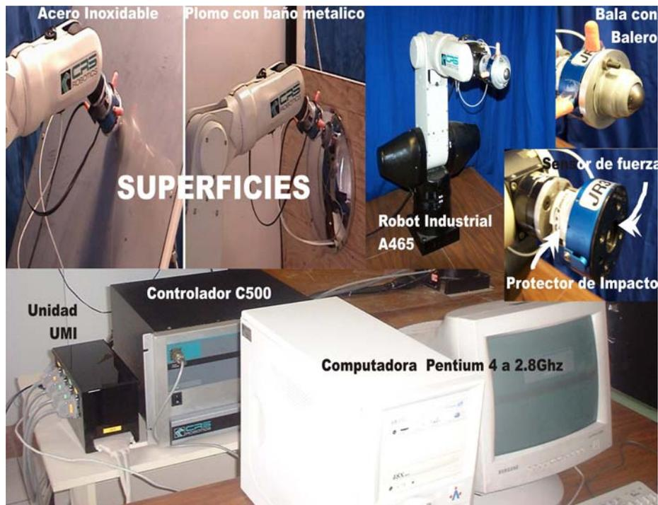
Figura A.1: Sistema experimental con componentes
