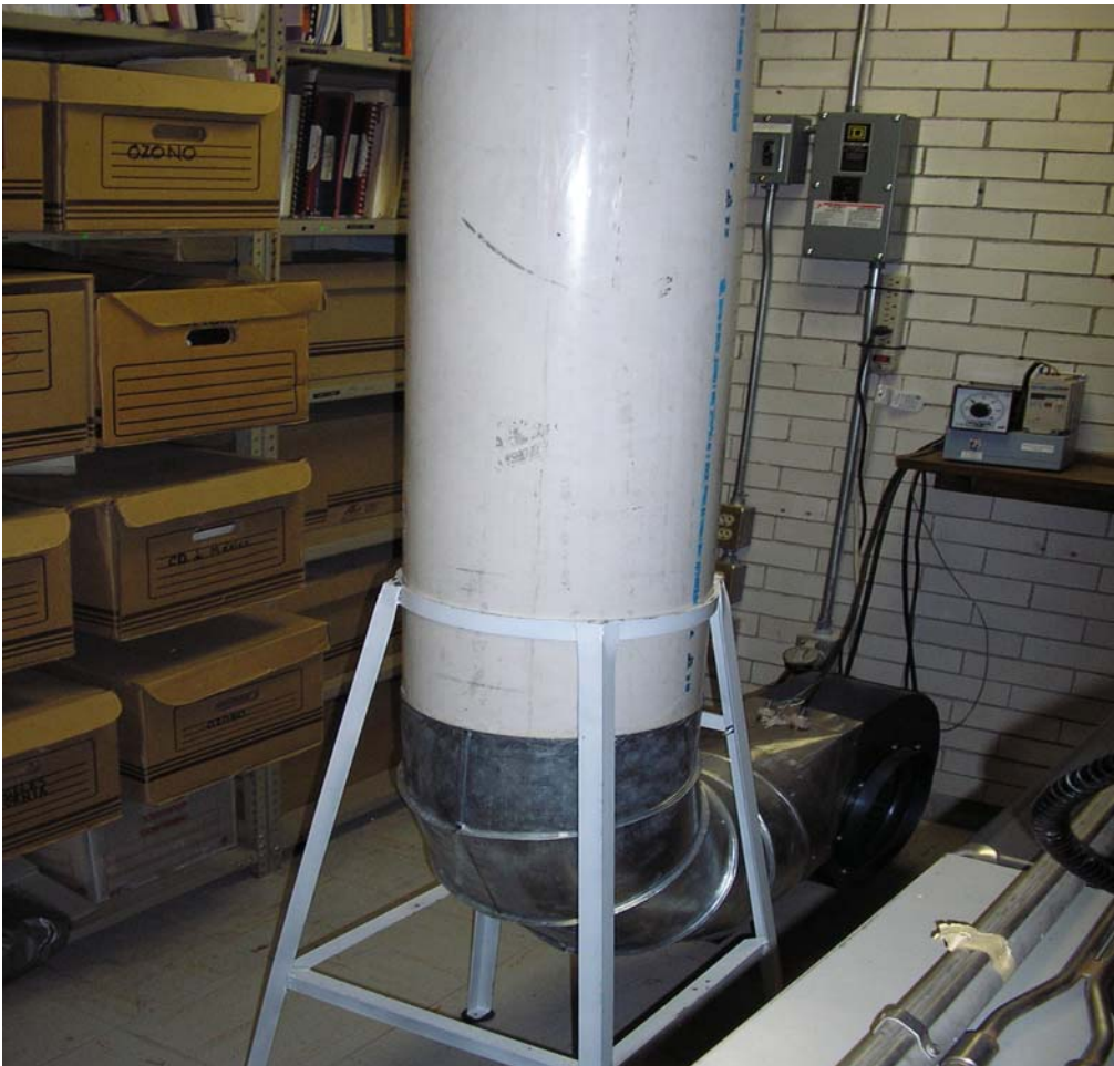
Acoplamiento del Ventilador con el Ducto
