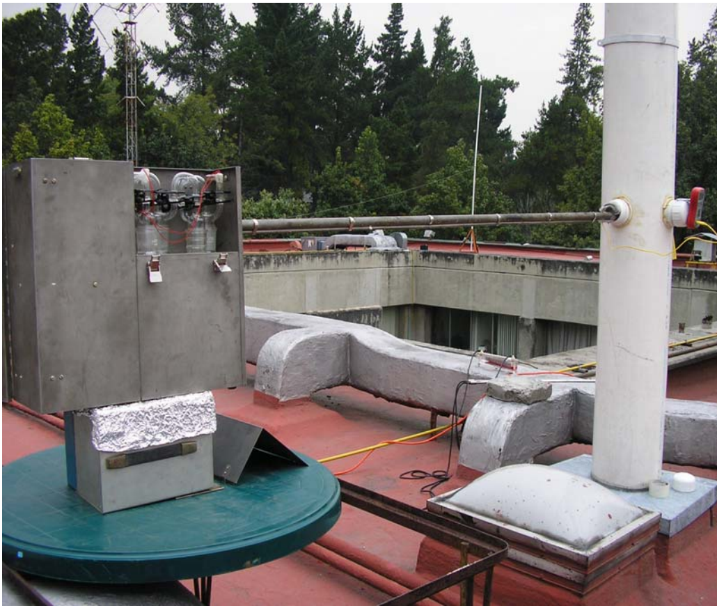
Tren de muestreo (caja de muestreo, sonda y medidor de temperatura)
