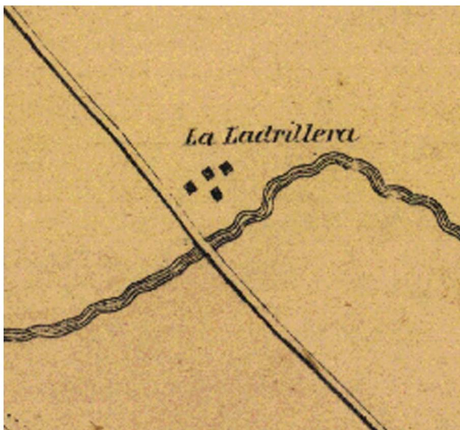
LÁMINA 12. Plan de la fábrica de ladrillo de Papias Anguiano en el año de 1865, ubicada al sur de Monterrey. Obsérvese la dispersión de los edificios y su proximidad al río, debido a la necesidad de mover máquinas hidráulicas para el batido de la masa. Tomado de: Plano de la ciudad de Monterrey y sus ejidos, Isidoro Epstein, año de 1865, escala 1:13,500, Colección Orozco y Berra, Mapoteca Manuel Orozco y Berra, Varilla OYBNL 1, Número 901.
