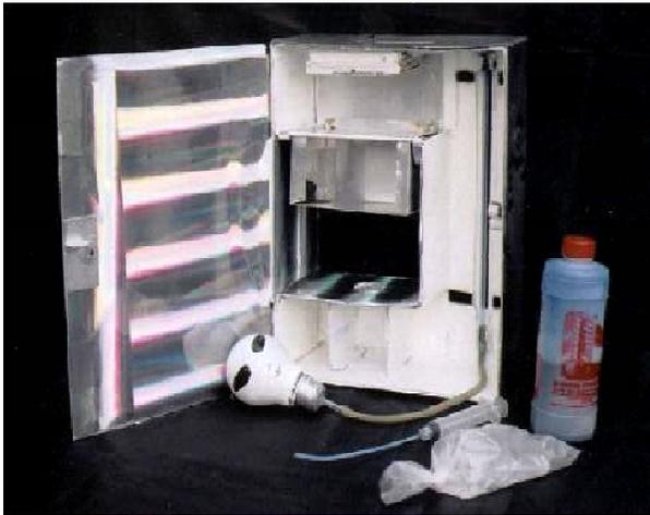
**Fig.5.a.** Muestra la posición del termómetro de alcohol dentro de la caja así como los materiales utilizados para su funcionamiento.
