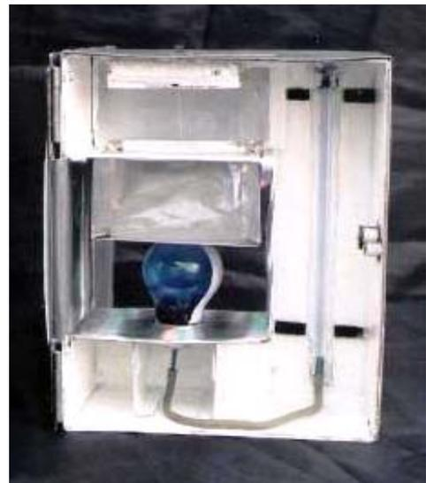
**Fig.5.b.** Muestra cómo la bolsa con hielo tiene contacto con la superficie del foco.
