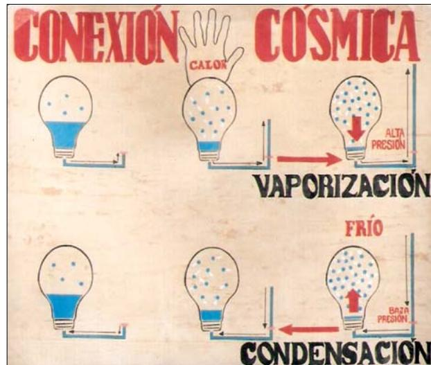
**Fig.10.a.** Ilustra cómo se lleva a cabo el cambio de fases del alcohol, además del comportamiento de las partículas.
