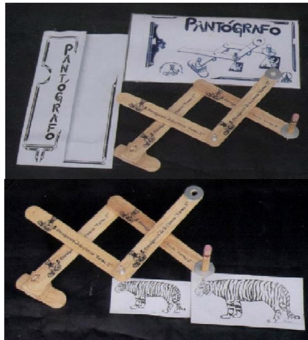
**Fig.2.** Pantógrafo junto con tríptico y dibujos.
