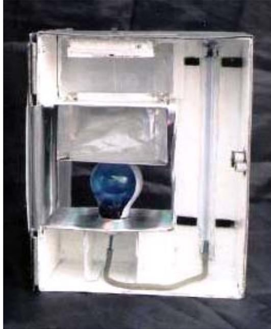
**Fig.11.a.** Muestra cómo la bolsa con hielo tiene contacto con la superficie del foco.
