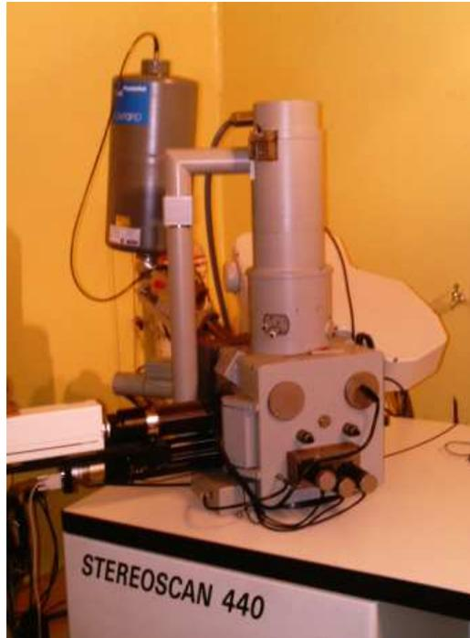
Fig 2.8 Microscopio electrónico de barrido. Cambridge Stereoscan 440
