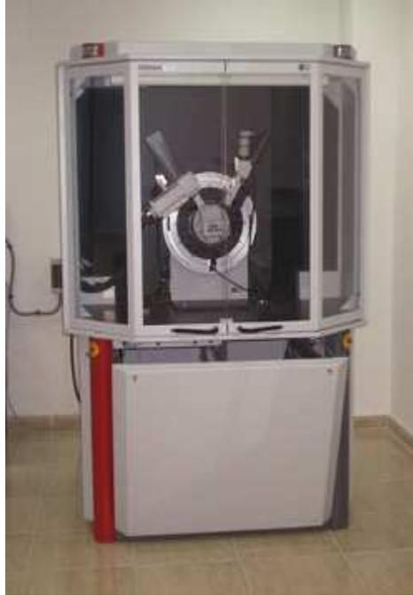
Fig.2.5 Difractómetro BRUCKER axs, Advance D8.
