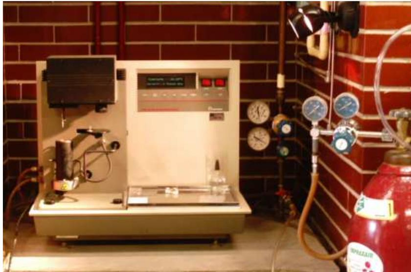
Fig. 2.9 Analizador Termogravimétrico TA Instruments modelo 2950.
