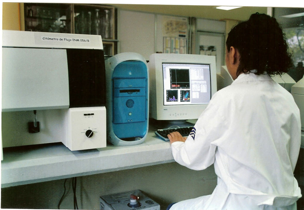
Figura.3 Citómetro de flujo FACSsort (Becton Dickinson) usando como software el programa Cell Quest (versión 3.3) (Becton Dickinson). Fotografía tomada del Instituto Nacional de Referencias Epidemiológicas (INDRE).
