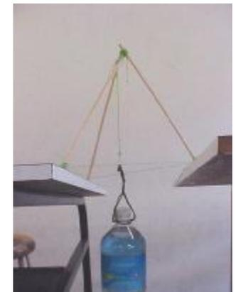
**Imagen 32** Modelo de análisis de tetraedro con barras de madera y cables de hilo Nylon con carga en nodo, unión puntual.<sup>41</sup>
