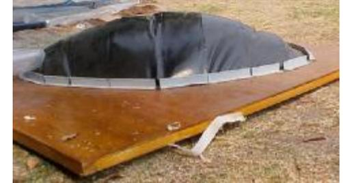
En uno de los extremos de la lona, se realizó una perforación y se conectó un ducto que conduciría el aire hasta el interior. Con esto se demuestra la posibilidad de usar diversos sistemas constructivos y que las formas también se deba al sistema que se utilice. Al plantear una estructura, antes se deban determinar los requerimientos del usuario y el tiempo como factor preponderante de utilidad y valor monetario.
