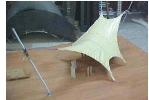
**Imagen 88** Modelo de lona con seis cortes.<sup>97</sup>
