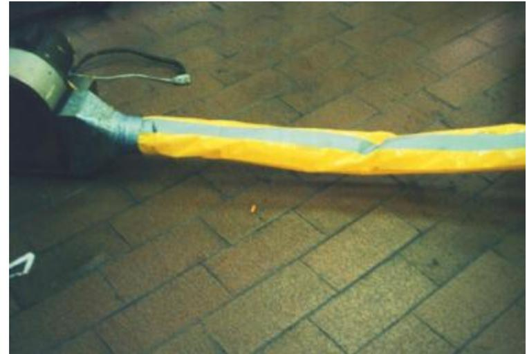
Imagen 56 Ducto de conexión del motor a la maqueta.<sup>65</sup>
