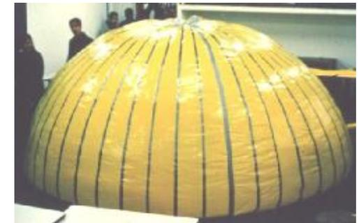
**Imagen 54** Neumática de baja presión de polietileno. <sup>63</sup>
