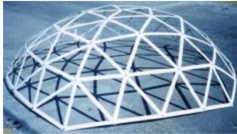
La decisión fue usar solera de aluminio de 1 ½” de ancho atornillado en cada extremo. Para este caso se consideró la segunda división de la cúpula y se tomaron las dimensiones que el dibujo determinó. Se procedió al corte del material tomando en cuenta un aumento en cada extremo para realizar el barreno y con esto mantener sin modificación el punto de intersección entre barras. Como ya es conocido, se
