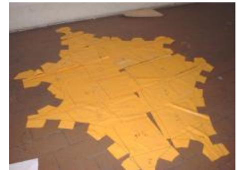
**Imagen 97** corte de material (vinilona) preparado para unirse con pegamento.<sup>106</sup>
