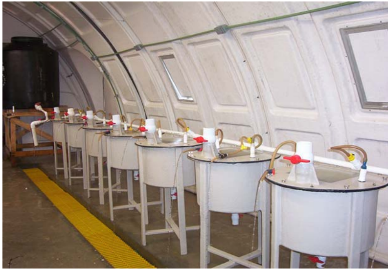
Fig. 3. Cámaras respirométricas utilizadas para O. maya
