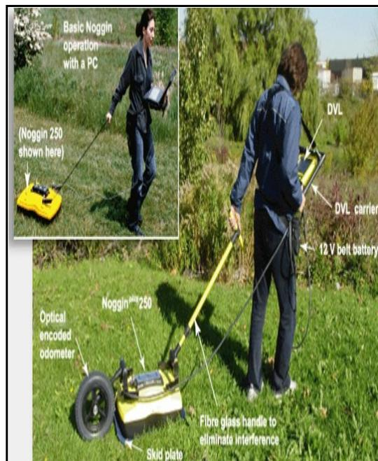
**Figura V.18.** Equipo de GPR Noggin 250, con el que se adquirieron los datos de campo, con una frecuencia nominal de 250 MHz, suministrado por Greg Johnston de la compañía Sensor & Software (Figura tomada de [www.sensor&software.com](http://www.sensor&software.com)).
