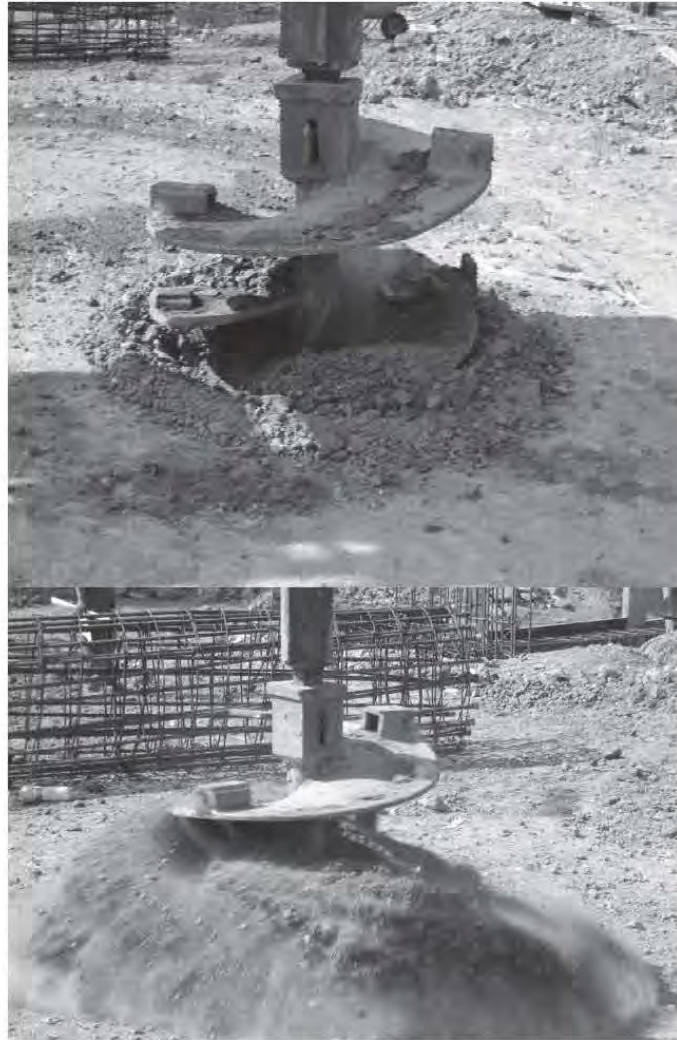
Fig. 2.3.3 Brocas helicoidales para corte
