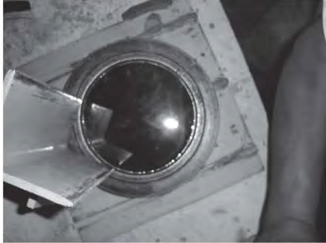
Fig. 2.5.21 a 2.5.23 Vaciado de azufre en molde para cabeceo
