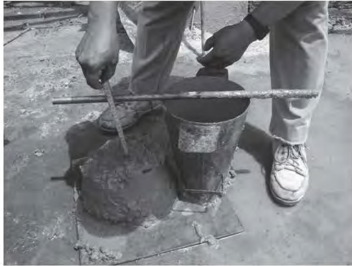
Fig. 2.5.11 Medición de revenimiento
