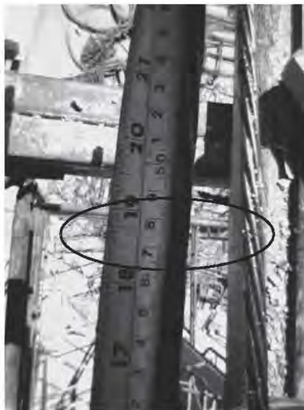
Fig. 3.8.19 Al liberar presión se observa que existe una retracción de 2.3 cm. aproximadamente, obteniendo una elongación de 7.7 cm.
