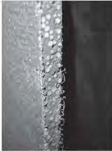
Fig. 4.3.10 Corte de panel de cemento en donde se aprecia el refuerzo de malla de fibra de vidrio
