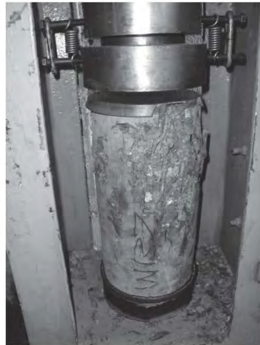
Fig. 2.5.28 a 2.5.31 Ensayo a compresión de cilindros en la prensa universal
