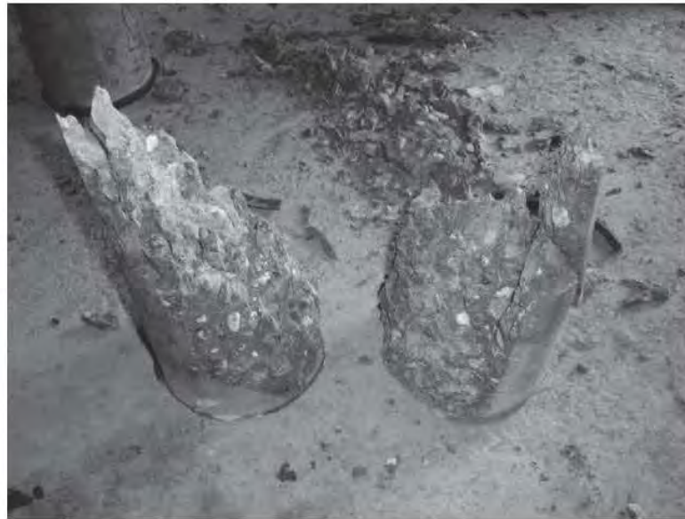
Fig. 2.5.33 Cilindro llevado a la falla
