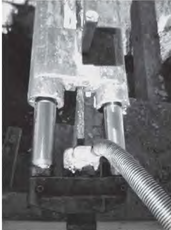
Fig. 3.8.17 Aplicación del esfuerzo máximo de tensión
