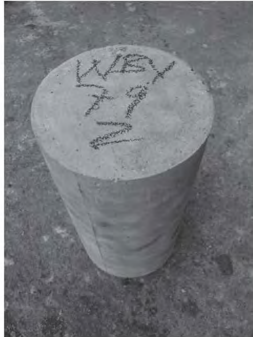
Fig. 2.5.20 Cilindro descimbrado e identificado
