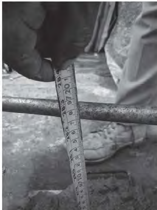
Fig. 2.5.12 Revenimiento de 17 cm.
