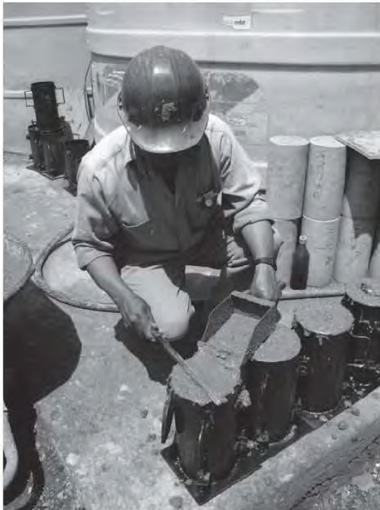
Fig.2.5.18 y 2.5.19 Enrase de cilindros
