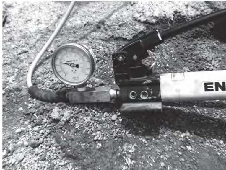
Fig. 5.1.31 Manómetro que indica la carga aplicada
