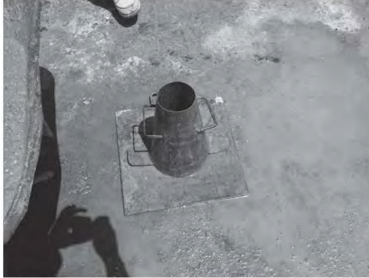
Fig. 2.5.5 Cono de revenimiento y plancha metálica humedecidos
