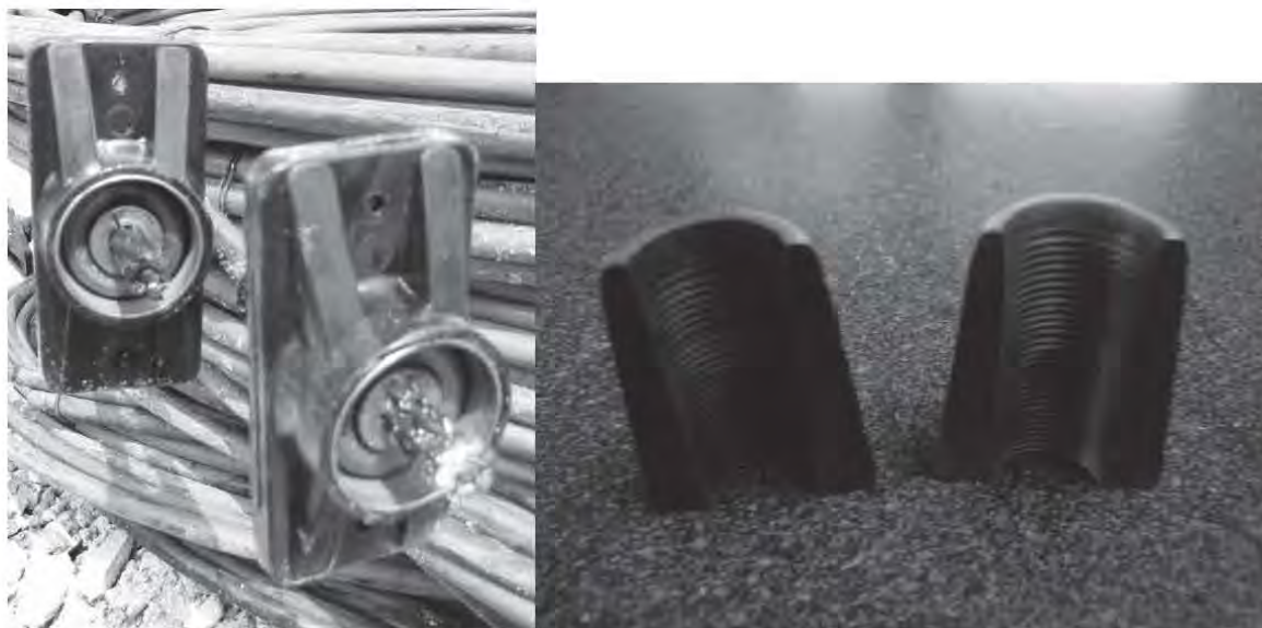
Fig. 3.6.15 y 3.6.16 Anclajes y cuñas sin defectos
