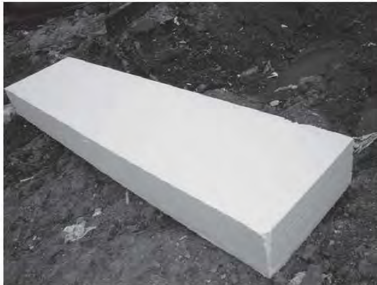
Fig. 3.5.6 Casetón de poliestireno para ajustes
