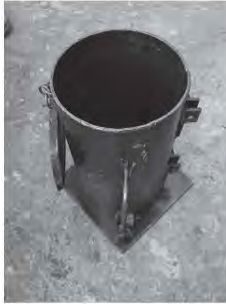
Fig. 2.5.13 Molde para cilindros de concreto
