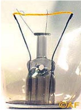
*La figura muestra un filamento montado en el tubo central de cristal.*
