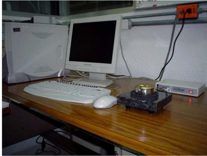
Fotografía de microscopio de barrido de efecto túnel (STM) y PC.
