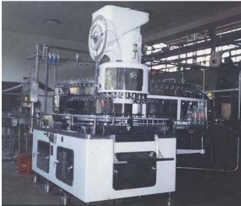
Figura 1.3. Máquina embotelladora de bebida (ejemplo de automatización fija).
