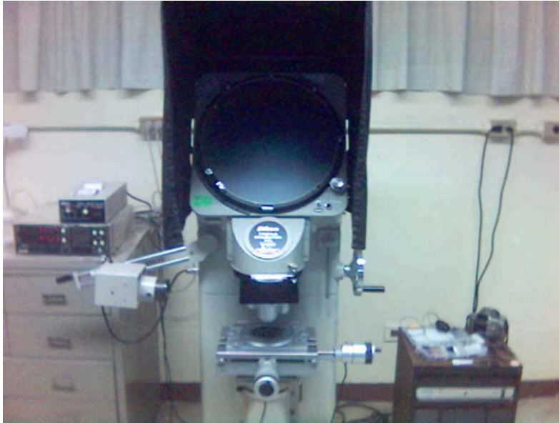
Figura 4.2. Comparador óptico marca “Nikon Profile Projector” modelo V-16D perteneciente al Laboratorio de Metrología del CCADET, UNAM.
