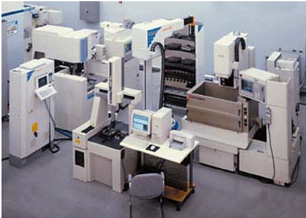
Figura 1.4. Celda de manufactura flexible que realiza operaciones de punzonado EDM y corte de electrodos.
