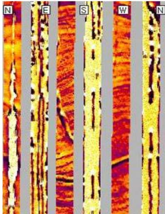
Fig. 7.15. Manifestación de gas entre la pared y los patines, debido a la alta resistividad del gas se observan franjas amarillas en vez de aspectos de la formación. Tomado de Chitale, et al., 2006.
