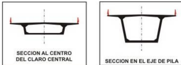
Imagen 3: Sección hueca de las dovelas del Puente Huayatlxco.
