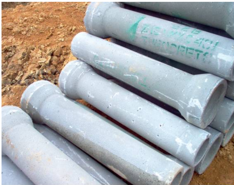
Fotografía 66: Tubos de albañal perforados para subdrenes.
