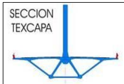
Imagen 2: Sección hueca del Puente Texcapa
