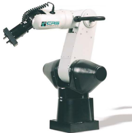
Figura 1. Robot CRS A465 para mesa de ensamble.
