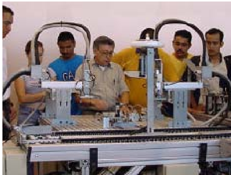
Figura 3. Robot cartesiano neumático para ensamble.
