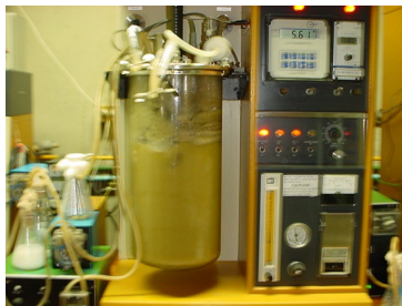
Fig. 6.3 Biorreactor de 10 L ubicado en la Unidad de Escalamiento y Planta Piloto del IBT/UNAM.
