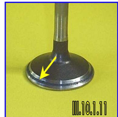
Asientos de válvula de escape con diámetro comprendido entre 35.0 mm. a 54.0 mm. se recomienda una superficie de contacto de 1.5 – 2.0 mm.
