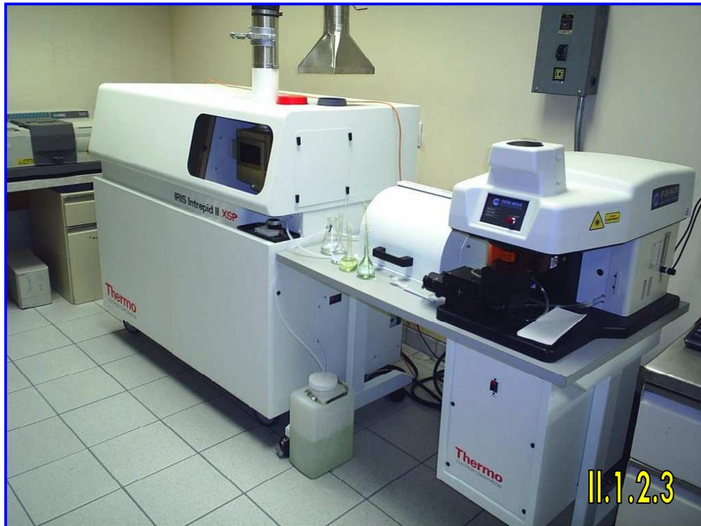
**G)** El Espectrómetro de Emisión por Plasma primeramente fue alimentado por el matraz que contenía el estándar de los elementos de aleación. Después el espectrómetro se alimentó con el matraz que contenía la muestra disuelta del Inserto Asiento de Válvula de Escape. Posteriormente el espectrómetro fue alimentado con la muestra disuelta del Inserto Asiento de Válvula de Admisión.
