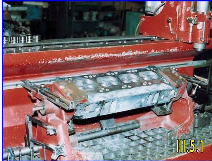
**Operación N° 2:** Después se inserta en la guía de válvula una guía de husillo y en ésta se inserta un nivelador horizontal. La cabeza se acomoda hasta que quede la guía de husillo a 90° guiándose por el indicador del nivelador y se aprieta con fuerza el maneral lateral para fijar la cabeza en esta posición como lo muestra la fotografía III.5.2.
