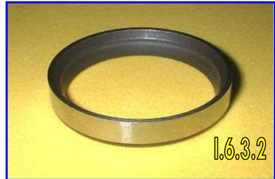
El asiento de válvula tiene una doble función. La primera función es el cierre perfecto de la válvula en relación a su base. La segunda es una función con respecto a la circulación de los gases, ésta es asegurada por los ángulos inferior, superior y el ángulo de asiento.
