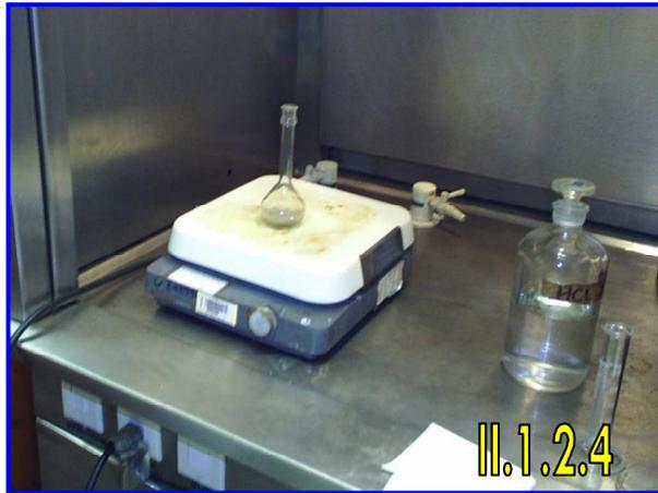
**I)** Una vez disueltas las virutas en el ácido clorhídrico, el matraz se retira de la parrilla eléctrica y es enfriado en chorro de agua. El matraz es aforado a 100 mililitros con agua desionizada.
