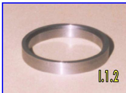
**Fotografía I.1.2:** Inserto Asiento de Válvula de Escape fabricado con acero AISI-SAE 4140. Se utilizó cámara digital samsung. Resolución 2 megapíxeles.
