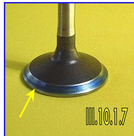
Para maquinar el ángulo inferior a  $60^\circ$  que determinará la superficie de apoyo, se escoge una muela para rectificación cónica a  $60^\circ$ , atornillándose ésta en el husillo, como se muestra en la fotografía
