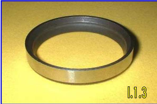
**Fotografía I.1.3:** Inserto Asiento de Válvula de Escape sinterizado de la cabeza del nuevo motor Dodge HEMI Magnum V8 de 5.7 litros. Cámara digital Samsung. Resolución 2 megapíxeles.
