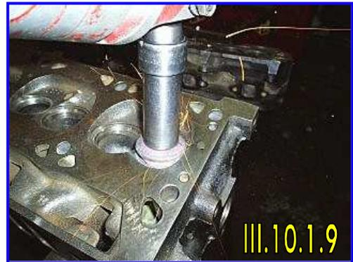
Se detiene el maquinado-rectificado verificando el ángulo a  $60^\circ$ , ver fotografía III.10.1.10. Se limpia el asiento de la cabeza de válvula de escape y se inserta en la guía de válvula haciendo que golpee varias veces en el asiento para que se imprima la superficie de apoyo, ver fotografía III.10.1.11.
