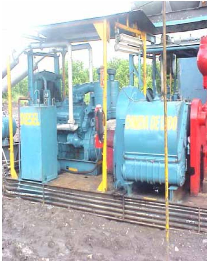
FIG. 16 BOMBA DE LODOS
