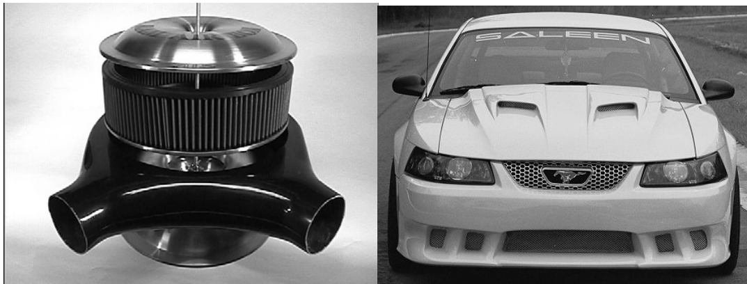
Fig. 1.6.1 Ram Air (Izq. dispositivo, Der. Adaptaciones a carrocería)
