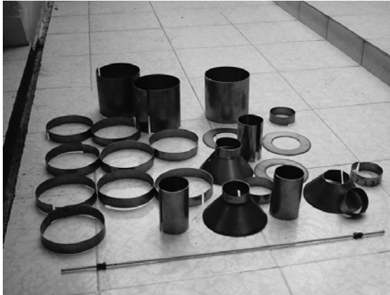
Fig. 3.1.1 Rolado de lámina para prototipo.
