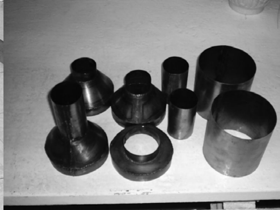
Fig. 3.1.2 Partes prototipo soldadas.
