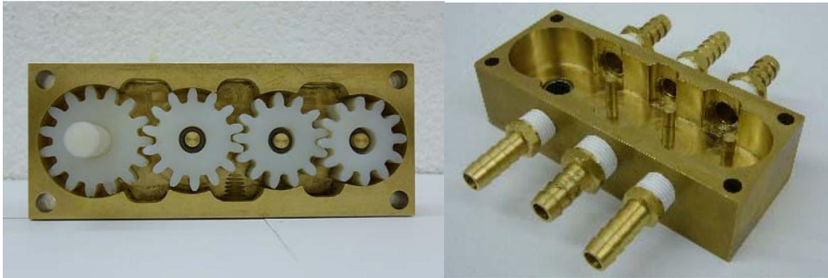
Fig. 29 Motor de cuatro engranes de diferente diámetro exterior
