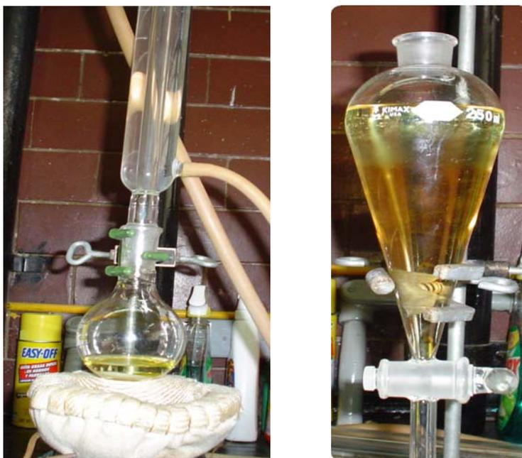
**Fig. 13. Etapa de saponificación (izquierda) y extracción líquido-líquido (derecha) con el método de la AOAC. El material utilizado tiene una capacidad de 250 mL.**
