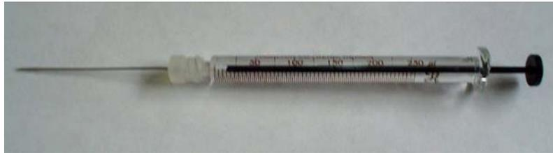
**Fig. 7. Jeringa de vidrio para introducción de muestra, capacidad 250  $\mu$ L.**
