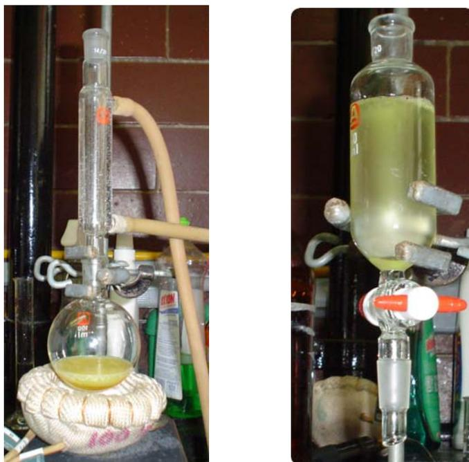
**Fig. 14. Etapa de saponificación (izquierda) y etapa de extracción líquido-líquido (derecha) con el material Quickfit.**
