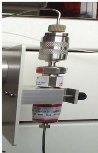
**Fig. 9. Columna analítica Luna C-18 de 50 mm de longitud.**
