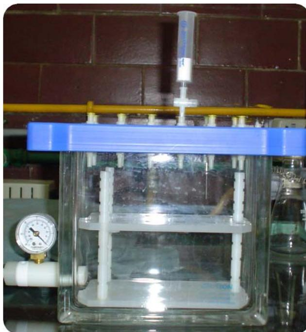
**Fig. 16.** Equipo de extracción con vacío en con los cartuchos en fase sólida (Manifold por su nombre en inglés).
