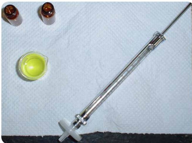
***Fig. 17.*** Equipo para filtración de la muestra antes de su análisis instrumental.
