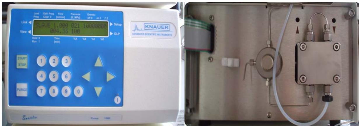
**Fig. 6. Sistema de bombeo cromatógrafo Marca Knauer y cabezales de los pistones de la bomba.**
