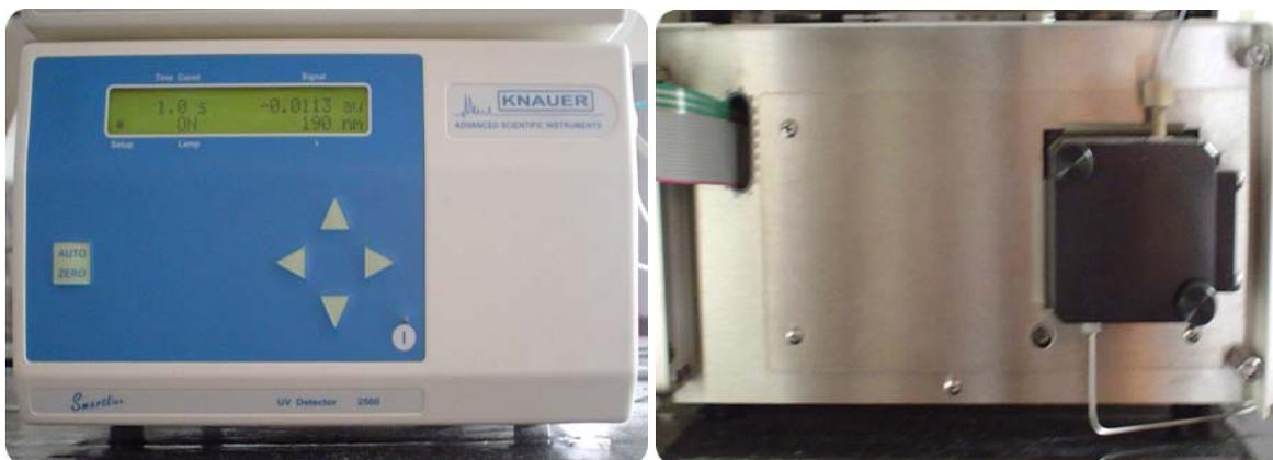
**Fig. 10.** A la izquierda se observa el detector UV-Visible del cromatógrafo de la marca Knauer, a la derecha se observa la celda de dicho detector.
