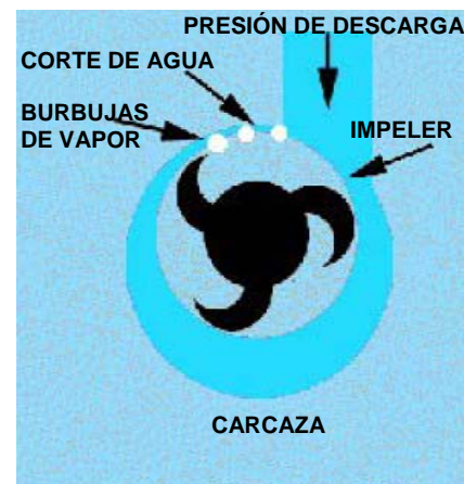
FIG. 3.21 CAVITACIÓN POR DESCARGA
