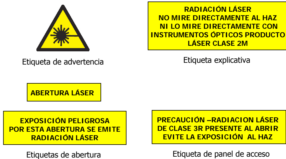
Figura 1.12. Ejemplos de las etiquetas de advertencia en dispositivos láser.
