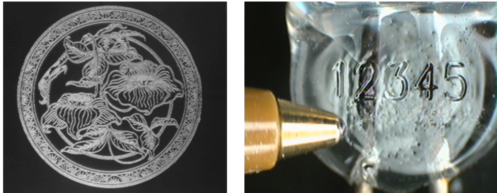
Figura 2.13. Marcado en vidrio con láser de CO 2 de 25 W ¡Error! No se encuentra el origen de la referencia. ].
