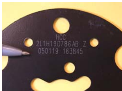
Acero revestido marcado con un láser de CO 2 de 25 W.
