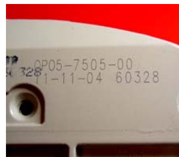
Aluminio revestido marcado con un láser de CO 2 de 25 W.
