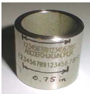
Tubo de metal con diámetro 1 [in] marcado con un láser de CO 2 de 100 W. Se marcaron 2 in/s.
