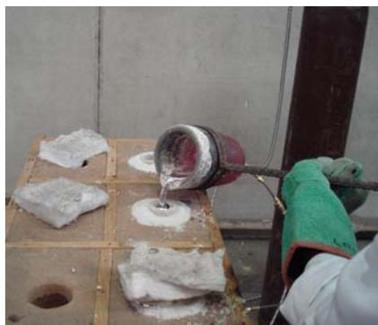
**Figura 32. Fotografía del procedimiento de vaciado de los moldes.**
