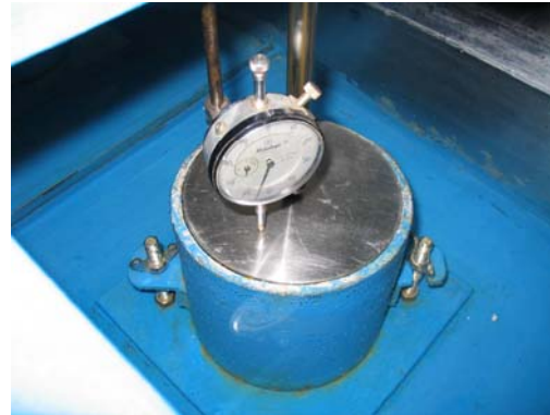
(b) Molde y micrómetro para medir deformaciones.
