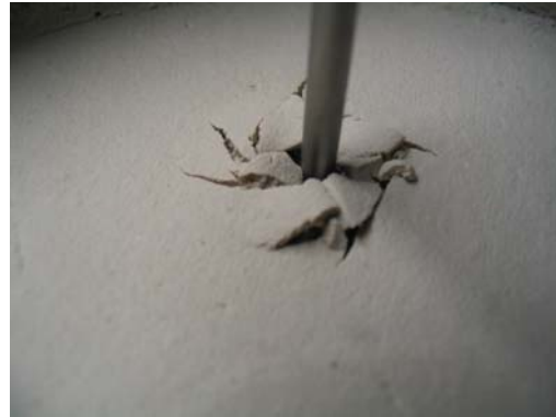
(b) Zona de falla durante el ensayo
