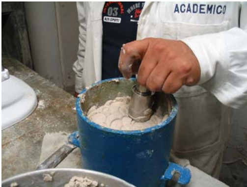
(a) Apisonamiento del material en capas.
