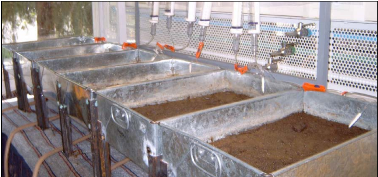
Figura III.12. Unidades experimentales de tratamientos fisicoquímicos (lavado de suelo por inundación y lavado mecánico).
