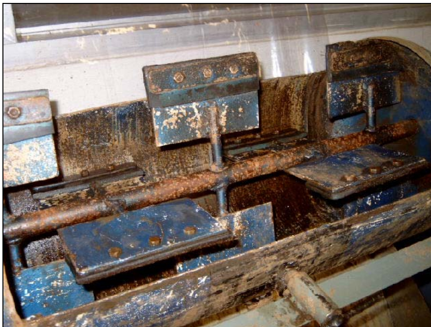
Figura III.17. Incrustación del petróleo en la mezcladora mecánica al utilizar el tensoactivo TW80 1%.
