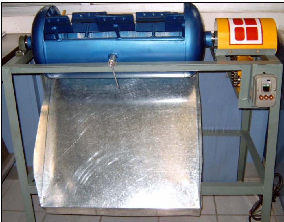
Figura III.14. Mezcladora mecánica para lavado de suelo (escala laboratorio: 10 L de capacidad).
