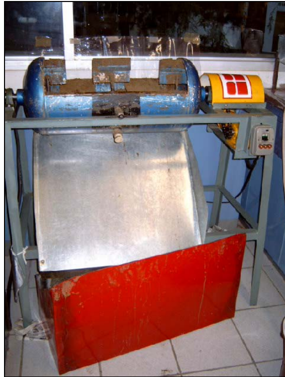
Figura III.16. Drenado del efluente en el lavado de suelo mecánico.
