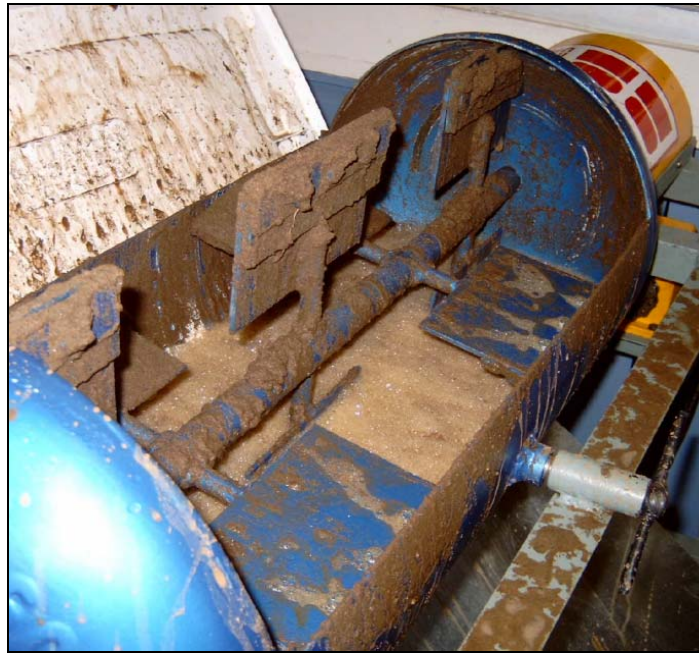
Figura III.15. Lavado de suelo mecánico con tensoactivo.
