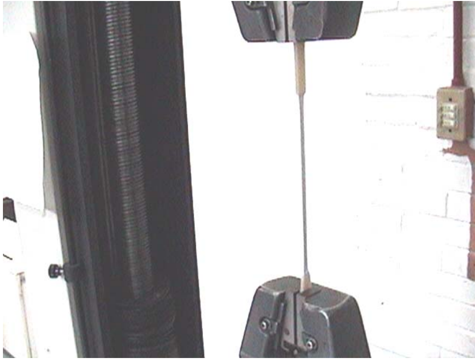
Figura 109. Ensayo de una probeta en progreso.
