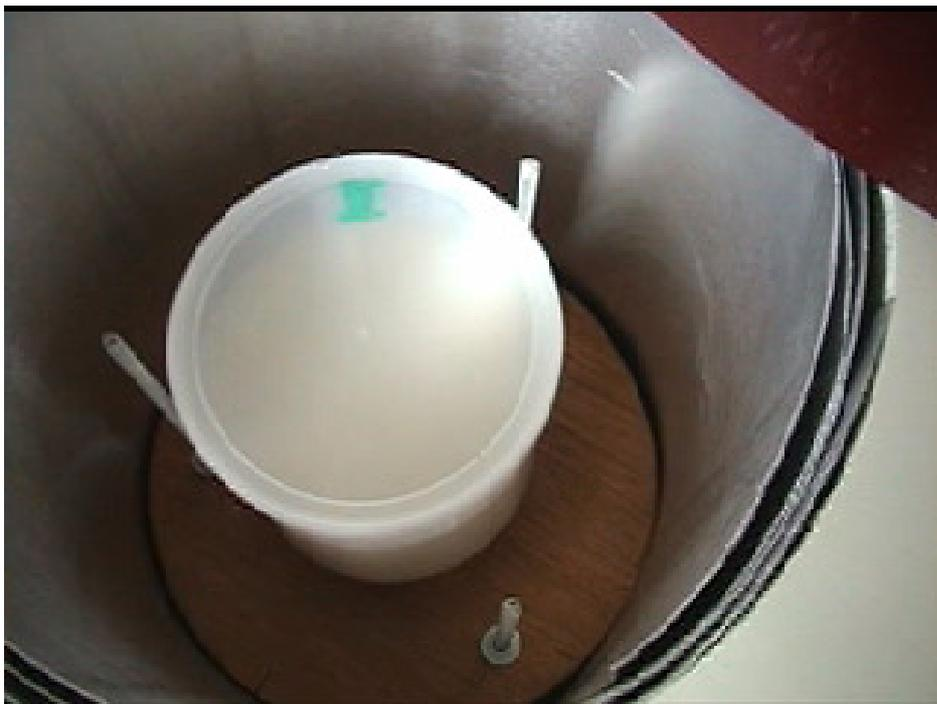
Figura 11: Marinelli con muestra en el pozo de detección.
