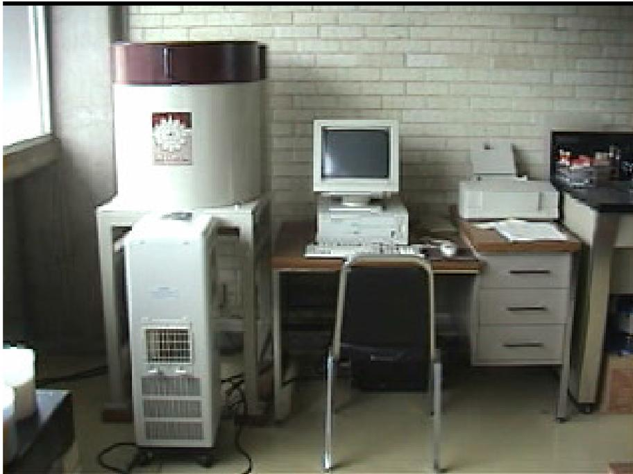
Figura : 8 Espectrofotómetro gamma con detector de centelleo de NaI(Tl) acoplado a una PC
