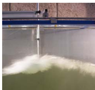
Fig.6.1.- Sensor de nivel utilizado para la medición de la variación de la superficie libre.
