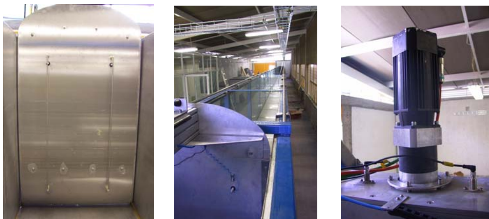
Fig. 6.3.- Dispositivo de generación de oleaje.
