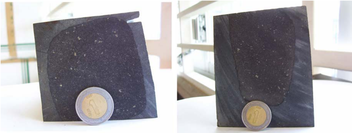
Figura 20. Basaltos del piso oceánico de la Placa Rivera. Las fotografías muestran una zona interior más oscura y una zona exterior gris oscuro, los puntos verdes en la zona interior son cristales de olivino. La moneda mide 2 cm de diámetro.
