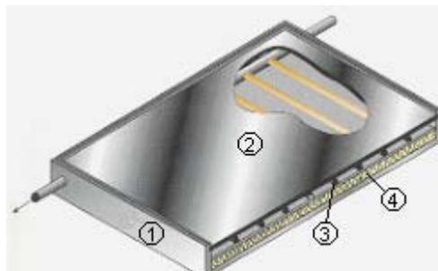
**Figura11.** Componentes principales de un colector plano. 1: Caja exterior, 2: Cubierta exterior, 3: Placa de absorción, 4: Aislamiento. **Fuente:** GARBITEK.
