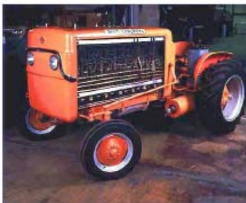
**Fig 63.** Primer vehículo en el mundo en ser energizado por una celda de combustible alcalina.
