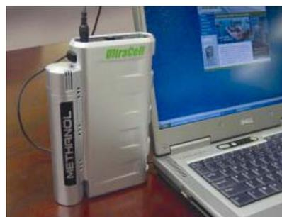
**Figura 62.** Celda DMFC y cartucho de metanol capaz de energizar una computadora portátil.
