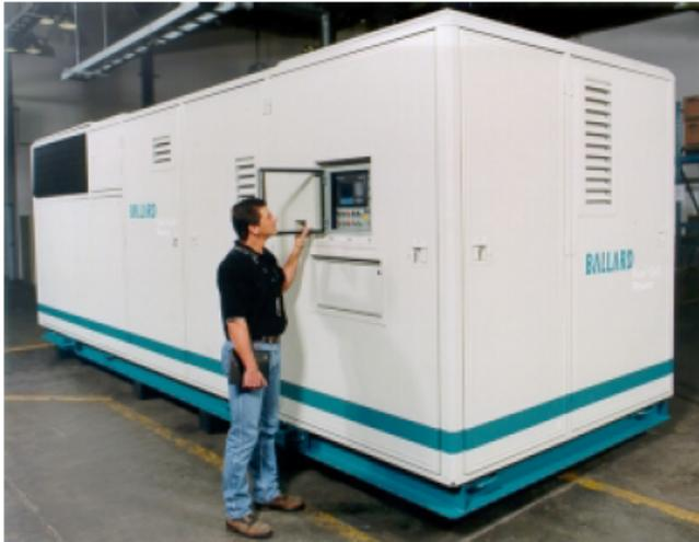
**Figura 56.** Planta de distribución de poder que funciona con celdas de combustible de óxidos sólidos. Esta unidad provee 250 Kw, la energía eléctrica y el calor generados son suficientes para aplicaciones industriales, una escuela o una comunidad con más de 50 hogares.
