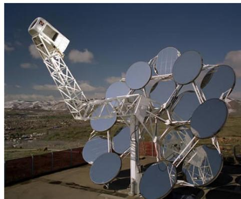
**Figura 19.** Colector de espejos planos con un punto común de concentración de energía. **Fuente:** Textos Científicos
