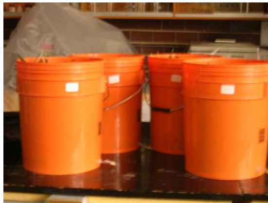
Figura 3.1 Reactores de "composta" utilizados
