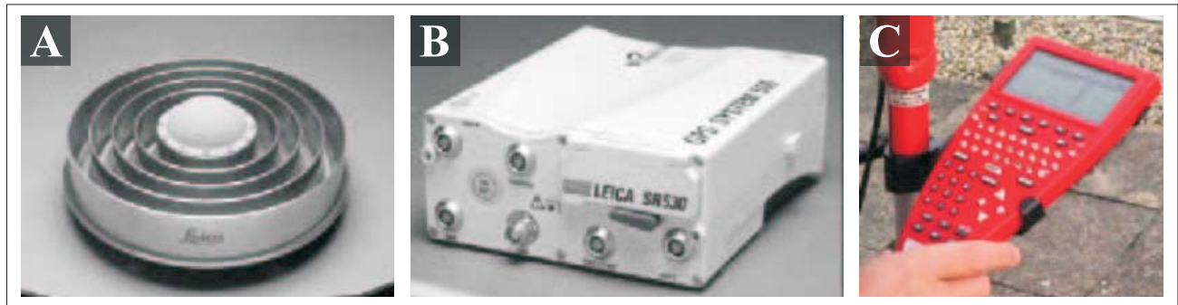
Figura 2.2. Elementos del segmento de usuarios. (A) Antena geodésica choke ring , (B) receptor GPS de doble frecuencia, y (C) terminal GPS.
