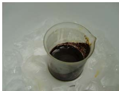
Figura 5.2 \text{Fe}(\text{NO}_3)_3 \cdot 9\text{H}_2\text{O} agitándose en el KClO filtrado.
