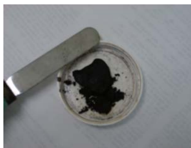
Figura 5.4 K_2FeO_4 ya filtrado, lavado y secado.
