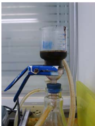
Figura 5.3 K_2FeO_4 filtrándose para eliminar el exceso de KClO .
