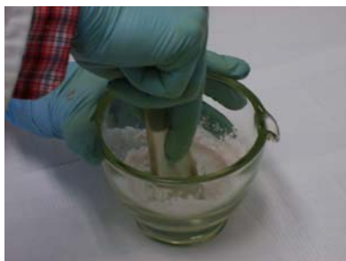
Figura 5.1 pulverización de \text{Fe}(\text{NO}_3)_3 \cdot 9\text{H}_2\text{O} para agregar al KClO
