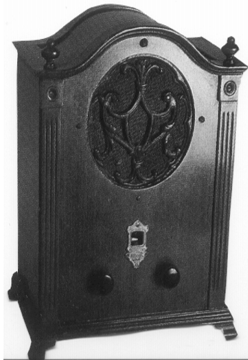
Receptor de mesa, 6 bulbos marca Sparks Company E.U1932
