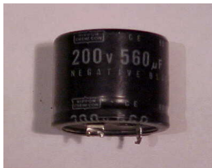
Condensador con capacidad impresa.
