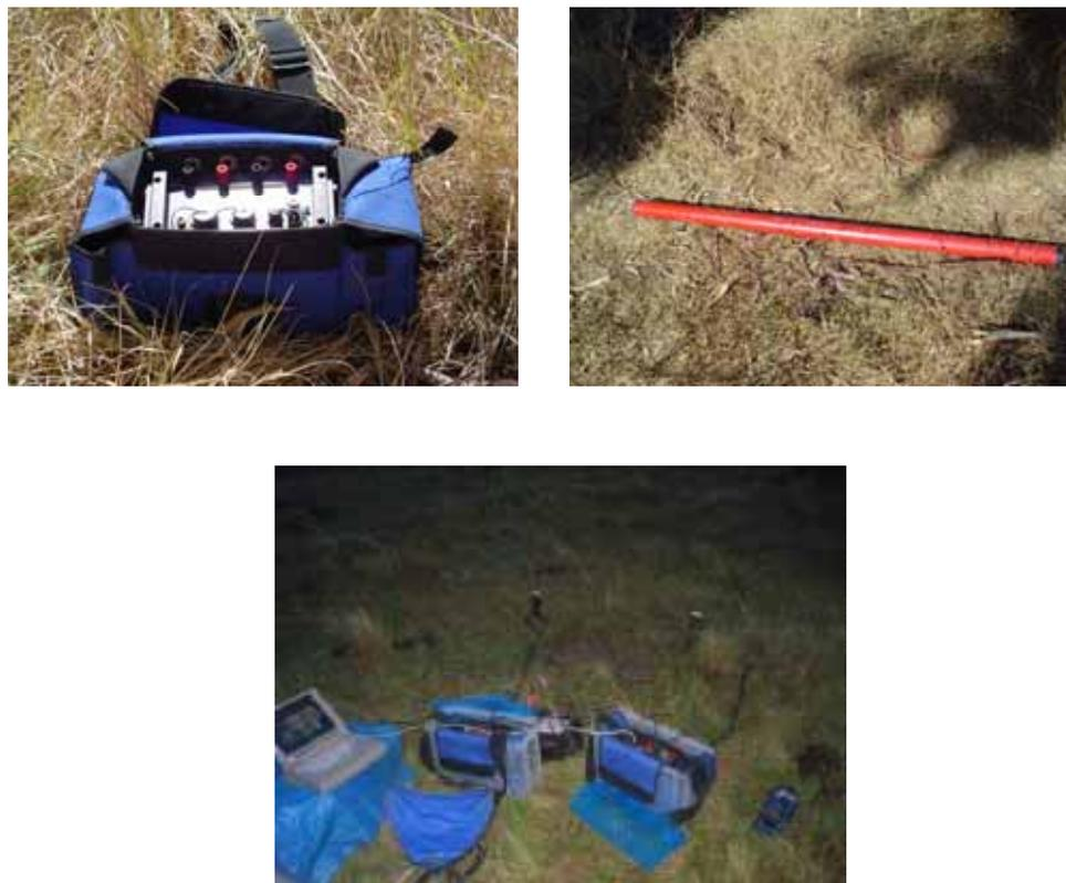
Figura 15. Fotografías del equipo central y de una bobina magnética.
