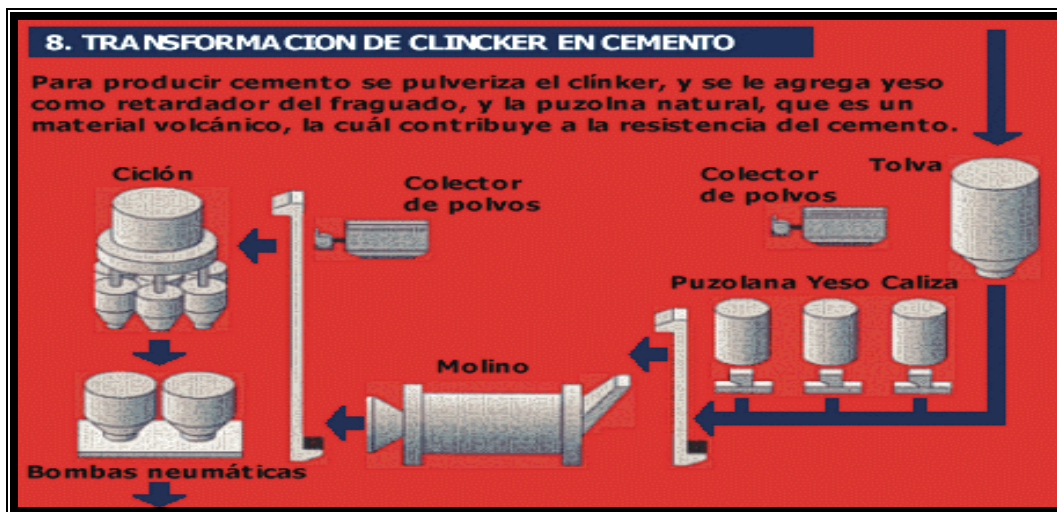
Fig. 10 transformación del clínker en cemento
