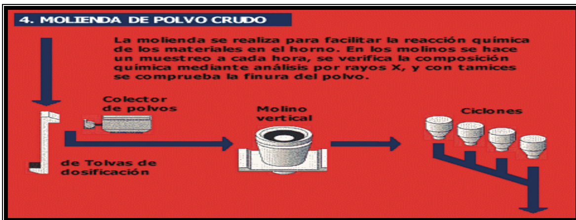
Fig. 6 molienda del polvo crudo
