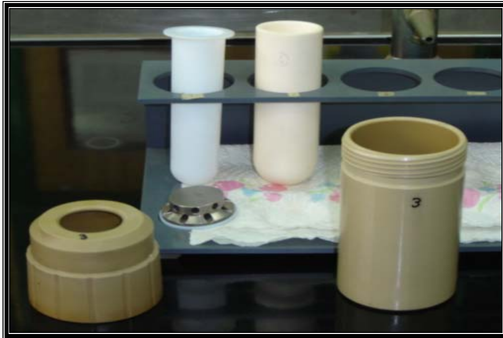
Foto 7 Las muestras debidamente pesadas se introducen en el tubo de teflón procurando que la muestra llegue hasta el fondo; al tubo se le coloca el tapón con demasiado cuidado para evitar que la boca del tapón sea mas grande que el diámetro del tubo de teflón; este tubo se coloca dentro del tubo de cerámica y por último se deposita dentro del vaso que esta enumerado y que forma parte del carrusel.
