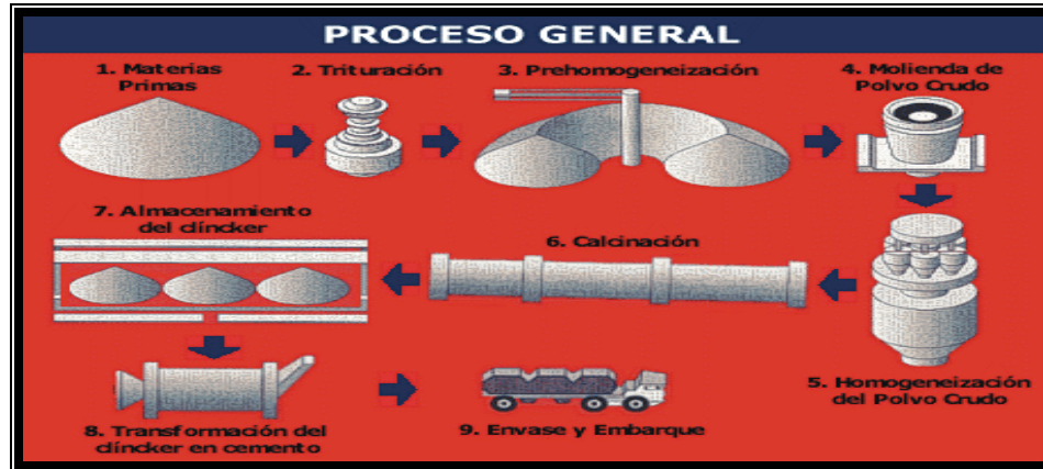
Fig. 2 Etapas de la producción de cemento
