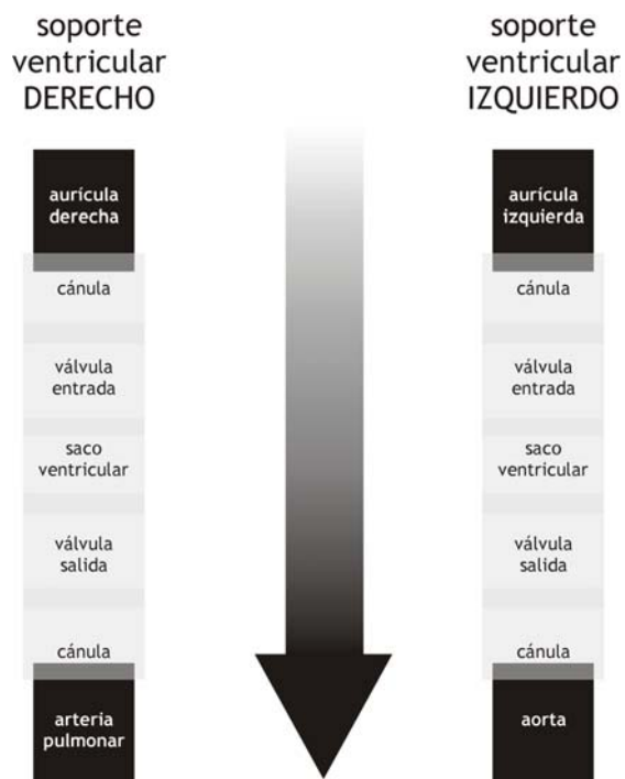
diagrama de circulación dentro del ventrículo artificial, tanto del lado izquierdo, como del derecho
