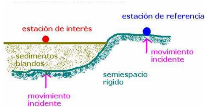
Figura 3.1. El movimiento en una estación de referencia es característico del movimiento de la interfaz roca-sedimento debajo de la estación de interés.
