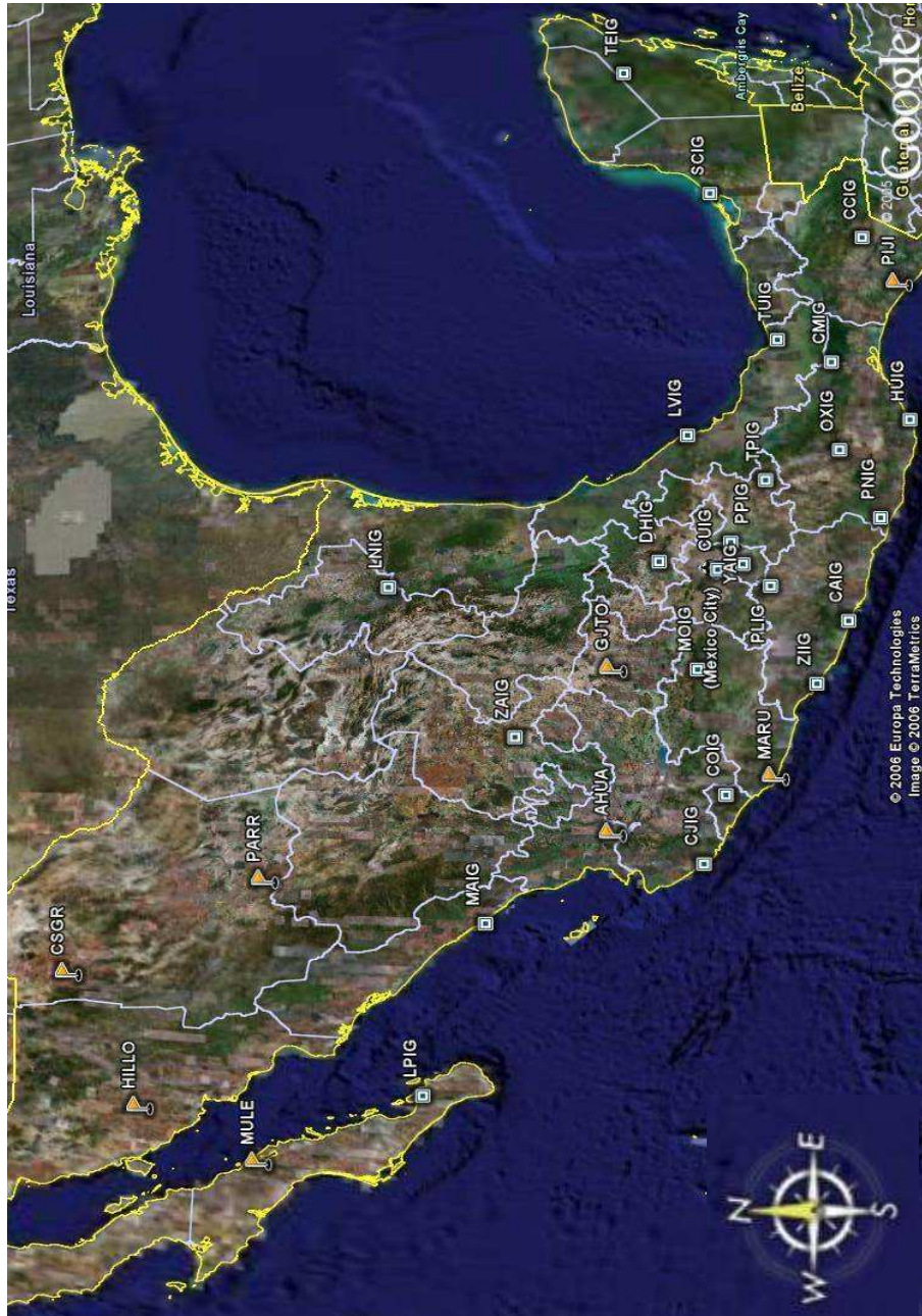
Figura 2.10. Mapa de distribución de las estaciones sismológicas de banda ancha del SSN, denotadas por los cuadros azules. Las estaciones propuestas están marcadas con banderas amarillas. El nombre correspondiente al código de las estaciones, se encuentra listado en la tabla 2.2
