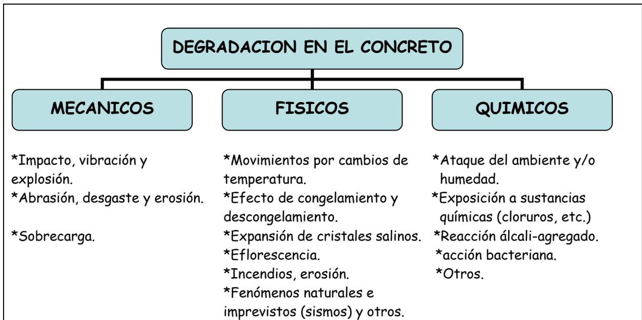
**FIGURA I.1.- Causas del deterioro en el concreto.**
