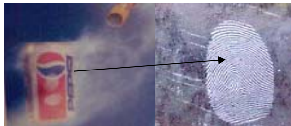
Figura 13. Huella digital latente con la técnica del Cianocrilato.
