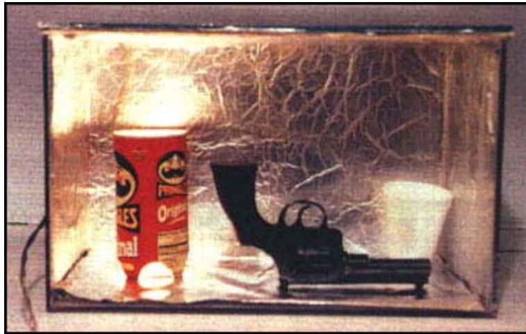
Figura 14. Cámara para la técnica de revelado del Cianoacrilato.
