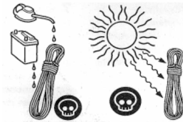
Fig. 2.8 Agentes que deterioran una cuerda
