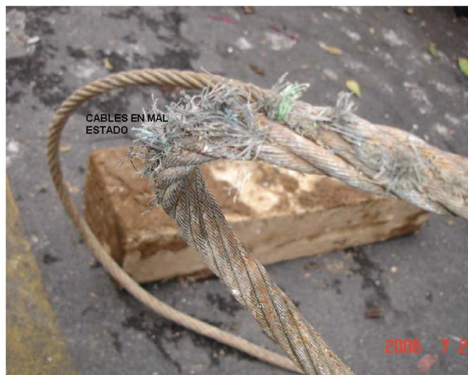
Imagen 4.10 Cables en mal estado
