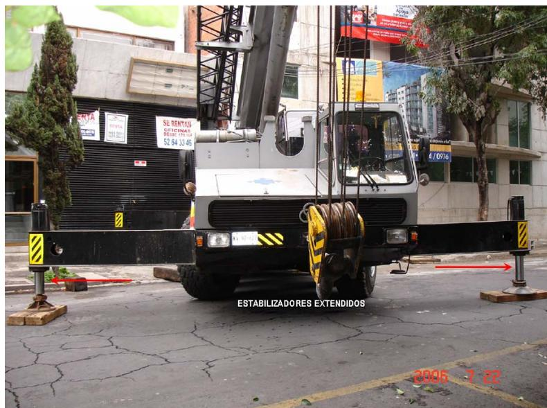
Imagen 4.15 Anclaje de la grúa auxiliar
