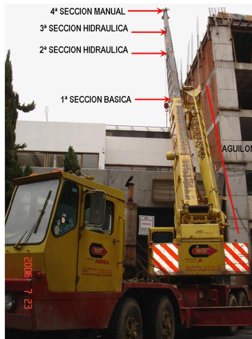
Imagen 4.6 Secciones de pluma de grúa hidráulica
